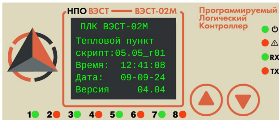
Рисунок 1 – Лицевая панель ПЛК ВЭСТ-02М
