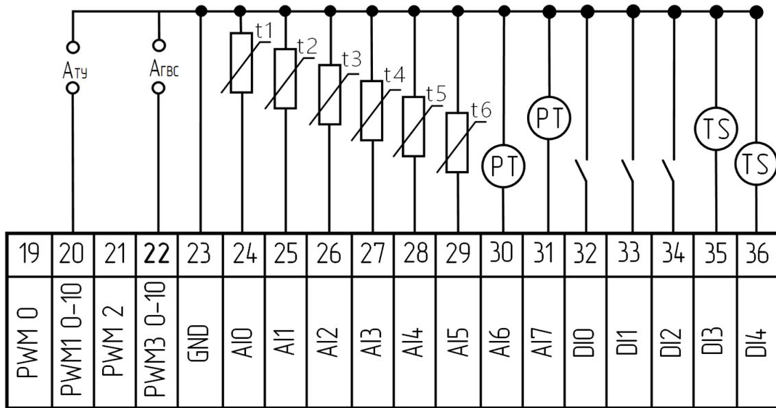
Рисунок Б.1 – Схема подключения верхней клеммной колодки
