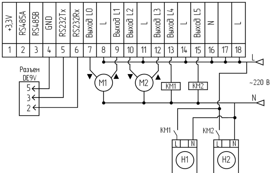
Рисунок Б.2 – Схема подключения нижней клеммной колодки
