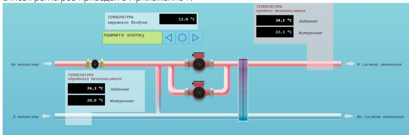
Рисунок 4 – Мнемосхема системы отопления
