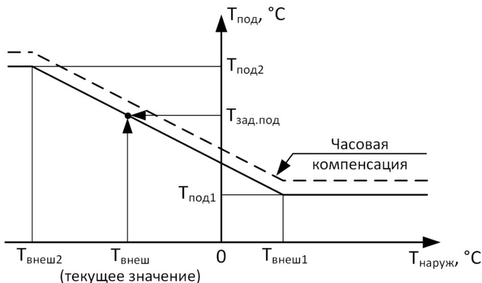
Рисунок 2 – Определение заданной температуры подающего водопровода системы отопления по точкам
