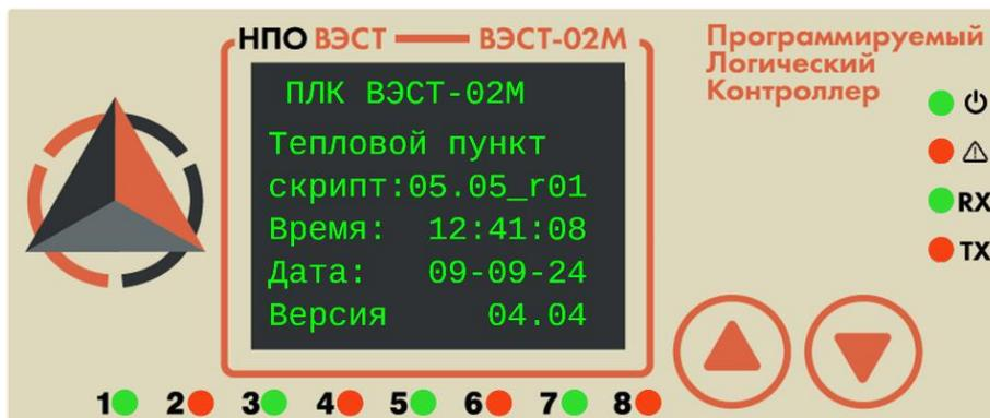
Рисунок 1 – Лицевая панель ПЛК ВЭСТ-02М
